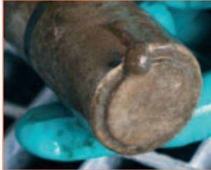
Sonde sans nettoyage à ultrason Au bout de 16 jours
