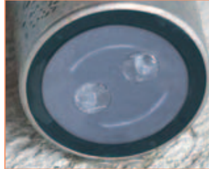
Sonde avec système de nettoyage à ultrason Au bout de 16 jours
