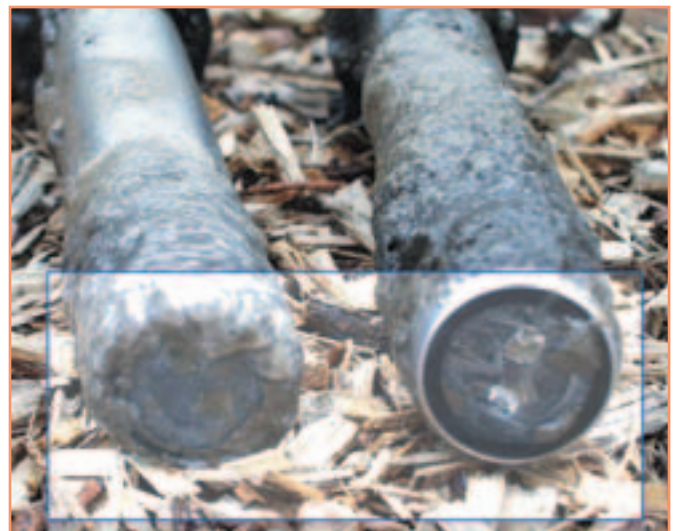
Sonde sans ou avec système de nettoyage ultrason
